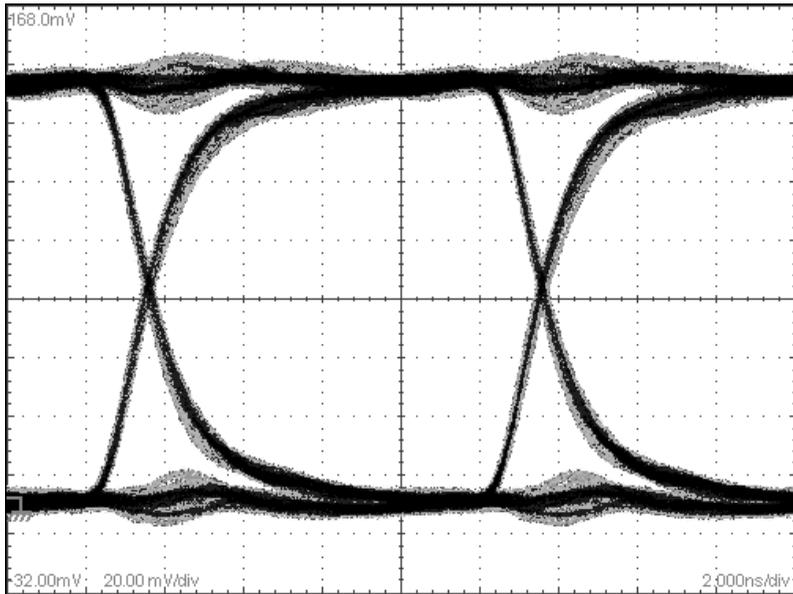
Figure 1. Eye Diagram<sup>1</sup>
