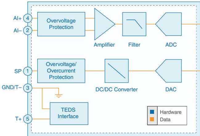
**Figure 9. FD-11601 Block Diagram**
