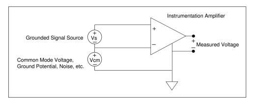
Figure 5-8. Common-Mode Voltage
