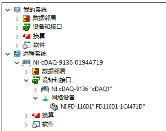
图 28. 将 FieldDAQ 设备添加到 MAX 中的 Real-Time 控制器
