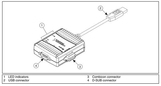
Figure 3-9. USB-LIN Connector Cable
