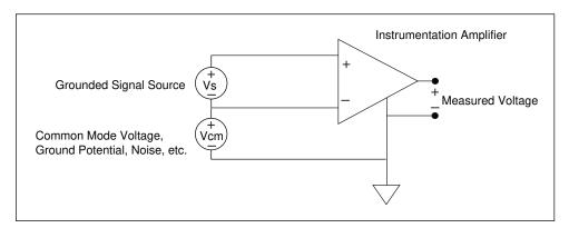
Figure 5-8. Common-Mode Voltage
