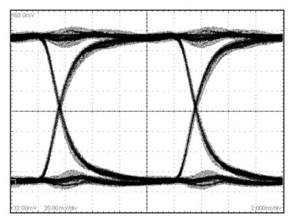
Figure 1. Eye Diagram<sup>1</sup>
